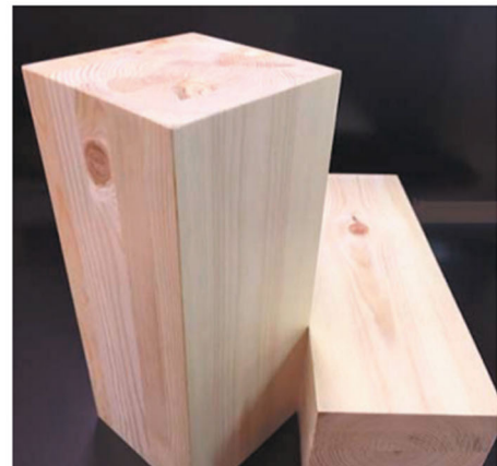
図 2-4 小断面集成材(柱・土台)
