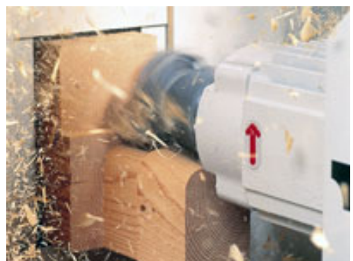
図 3-21 プレカット材の切削加工
