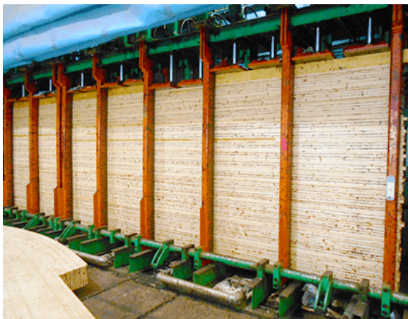
図 4-9 大断面用の大型プレス機
