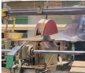
安全装置が破損
