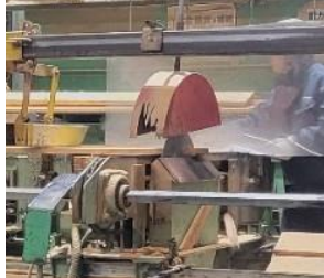
安全装置が破損
