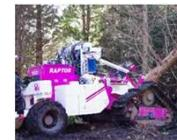
伐倒の遠隔操作化
