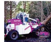
伐倒の遠隔操作化
