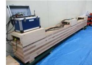
9層9プライCLTの性能評価試験の状況
