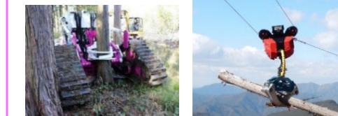
伐採等の自動化・遠隔操作技術の導入・実証
