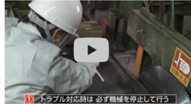
① トラブル対応時は必ず機械を停止して行う
