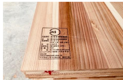
大径材の柂目板CLT
