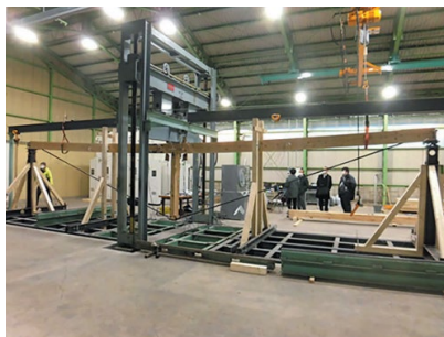
鋼材タイプ張弦トラスの実大強度試験(R2)
