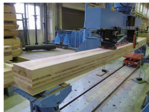
非等厚スギCLTの曲げ試験(R6)
