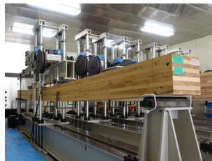
9層9プライCLTの 長期的な強度性能の測定(R6)
