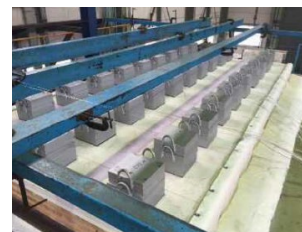
CLT床の載荷加熱試験(H27)
