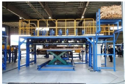
カセット式自動栈入れ装置板材角材兼用装置
