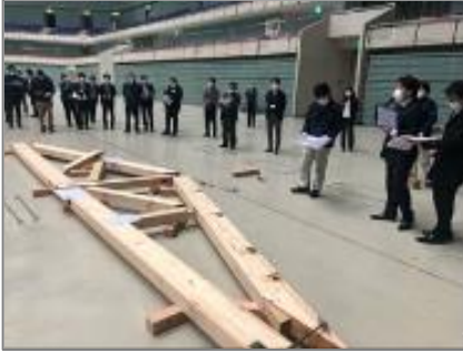
▲ 国産材を中大規模木造建築物の構造材に用いたトラス工法の開発や設計・施工手法の普及
