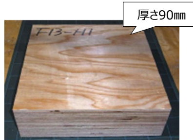
中高層建築物の床材への活用が期待できるスギ超厚合板の開発 ※通常の構造用合板は厚さ30mm程度で、住宅用床材への活用が中心
