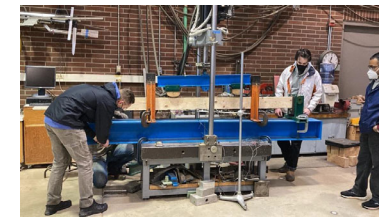
米国試験機関でのヒノキの 強度試験
