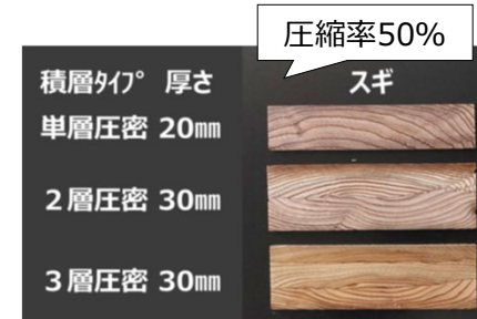
中高層建築物の柱材への活用が期待できるスギ圧密集成材の開発 ※積層圧密技術によりベイマツ集成材並みの強度を実現
