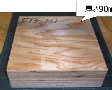
中高層建築物の床材への活用が期待できるスギ超厚集成材の開発 ※通常の構造用合板は厚さ30mm程度で、住宅用床材への活用が中心
