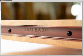
現地の気候条件等に対応するための反り止め金具の性能検証
