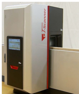
カメラ視認等による材面測定機器の例
