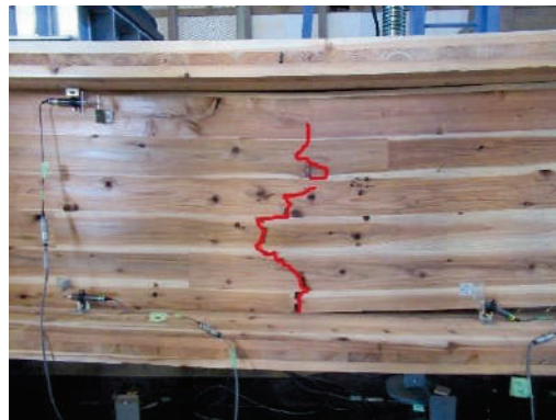
(c) ウェブ材の面内曲げ破壊
