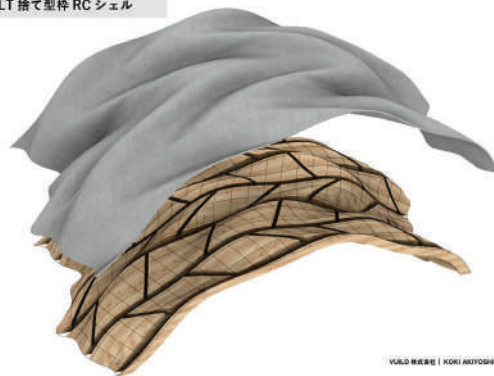
CLT 捨て型枠 RC シェル
