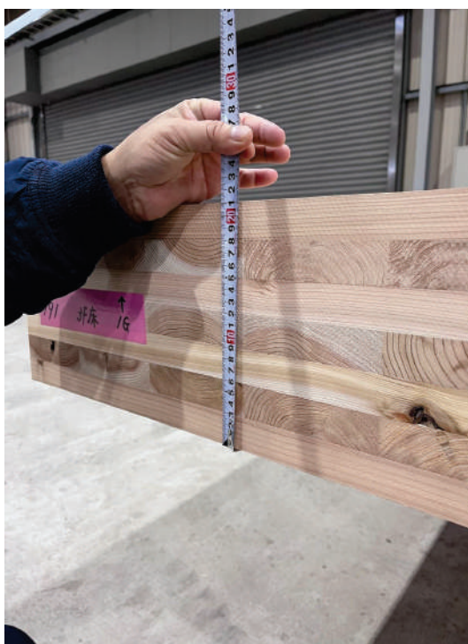
銘建工業岡山工場での製品検査（上 2 枚：壁パネル90mm下 2 枚床:パネル210mm）
