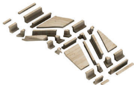
型枠を部品化する
