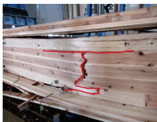
(c) ウェブ材の面内曲げ破壊
