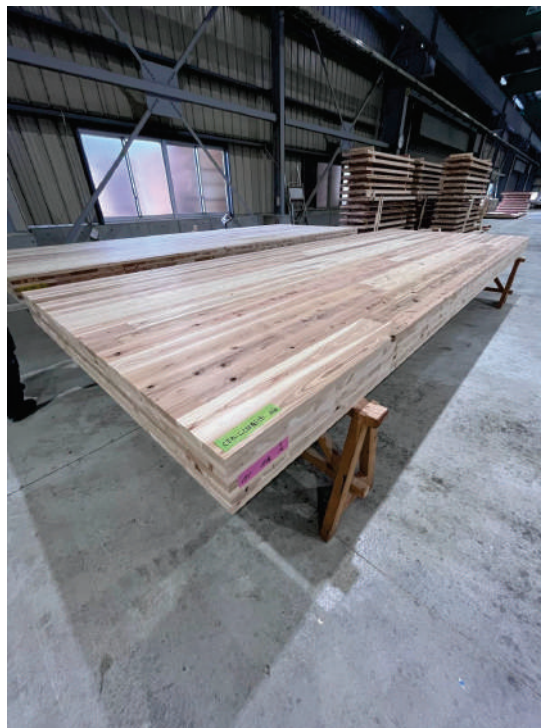
銘建工業岡山工場での製品検査（上 2 枚：壁パネル90mm下 2 枚床:パネル210mm）
