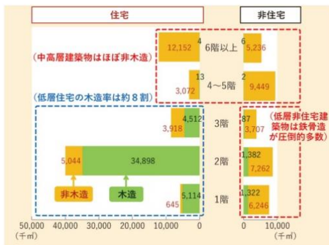
用途別・階層別・構造別の着工建築物の床面積。「住宅」とは、居住専用住宅、居住専用準住宅、居住産業併用建築物の合計であり、「非住宅」とは、これら以外をまとめたものとした。林野庁木材産業課が国土交通省「建築着工統計調査」（2022年）を基に作成（出所：林野庁「令和4年度森林・林業白書」） [画像のクリックで拡大表示]
