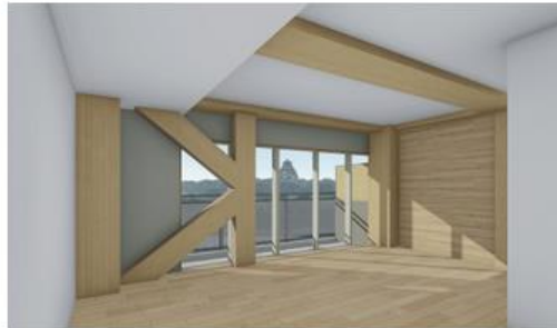
住戸の内観イメージ。木質耐火部材、LVLのK型ブレース、CLTの耐震壁、各木部を隠して仕上げる（出所：ビルディングランドスケープ） [画像のクリックで拡大表示]
