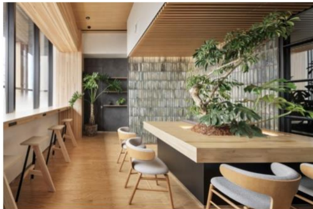
リフレッシュゾーン。左手に見える柱・梁に耐火集成材「燃エンウッド」を用いる。地産地消の観点から、テーブルやデスクの製作は宮城県の石巻工房に、いすの製作は山形県の天童木工に発注し、壁面のタイルは福島県の窯元である流紋焼の会津本郷焼を採用した（写真：ナカサアンドパートナーズ）
