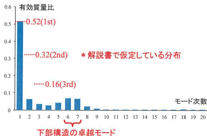
図 3.1-6 連続体モデルの解析解による各次モードの有効質量比
