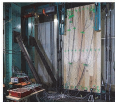
性能試験の様子（静加力実験）
