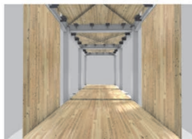
鉄骨フレームと CLT パネルの構成
