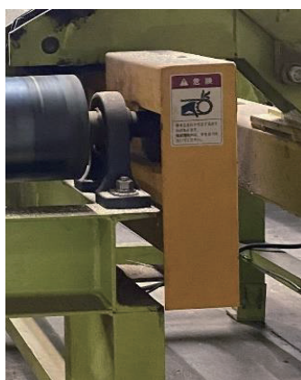
駆動部カバーの確実な取り付け
