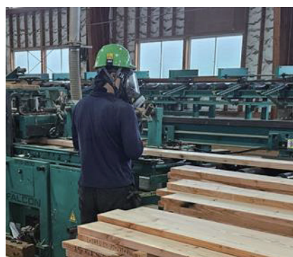
保護帽のインナー支給による巻き込まれ防止 防毒マスクの導入による保護
