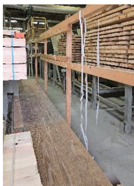
転落防止のための自作による柵の設置
