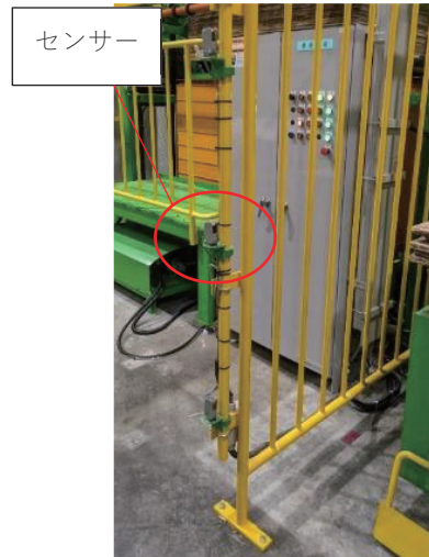
人の立ち入りを感知する センサーの取り付け
