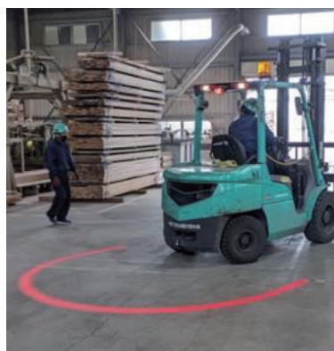
カーブミラーの設置やフォークリフトの存在を知らせるライトの導入
