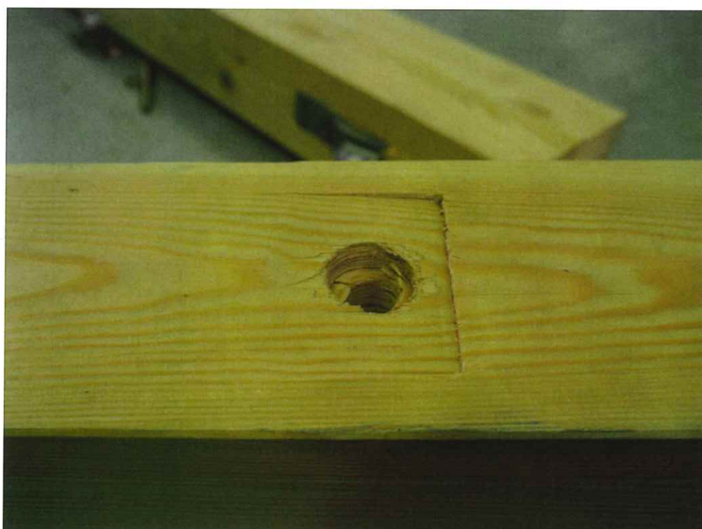
写真 2.22 T-HD 試験終了後 座金のめり込み
