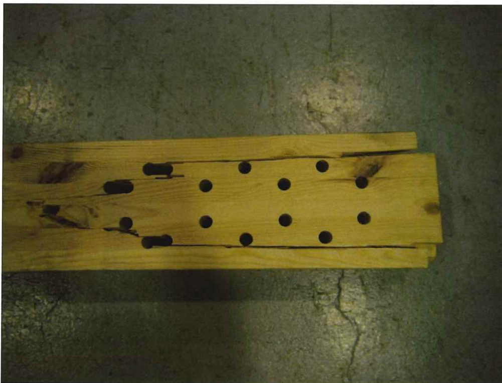
写真 2.6 T-CB-1 試験終了後 加力部の集合型せん断破壊
