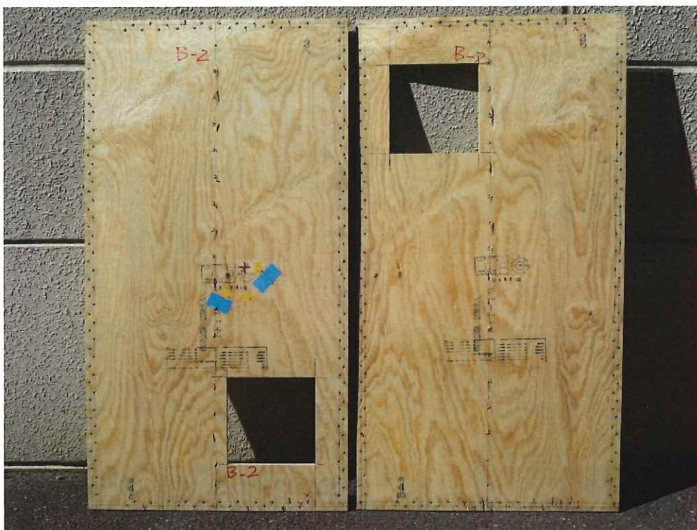
写真 1. 33 B-2 解体後 面材(表)
