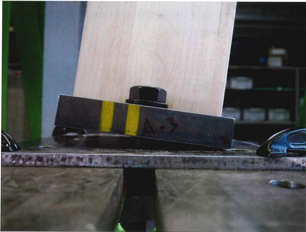
写真 2.17 M-CB 試験終了後 柱脚部拡大
