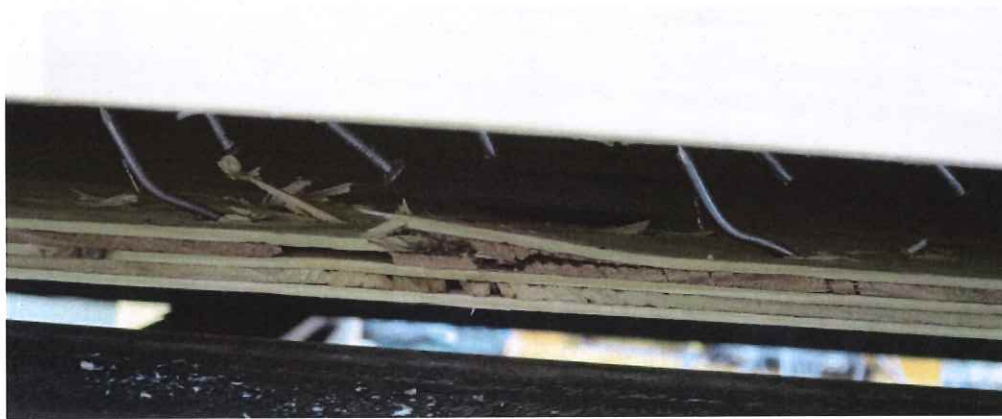
写真 1. 29 B-1 試験終了後 釘の抜け、釘の破断、パンチングアウト
