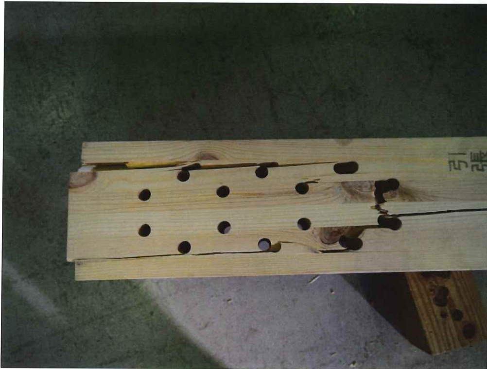
写真 2.9 T-CB-2 試験終了後 加力部の集合型せん断破壊
