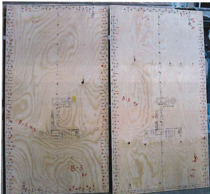
写真 1. 41 B-3 解体後 面材(裏)
