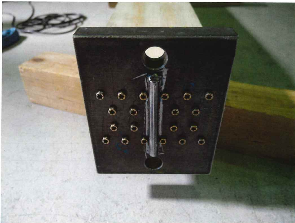
写真 2.18 M-CB 試験終了後 ビスおよび木材に破壊なし
