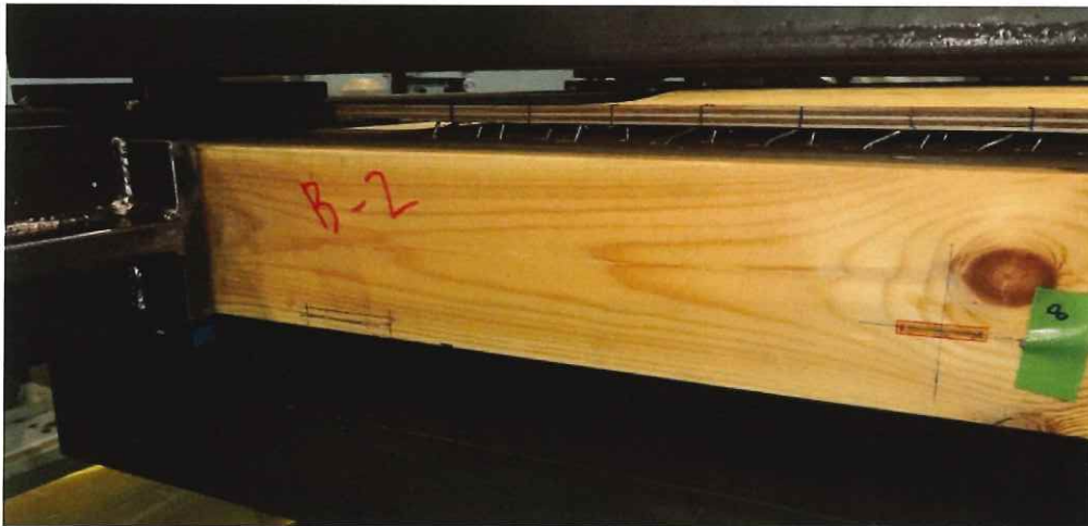
写真 1. 36 B-2 試験終了後 釘の抜け、釘の破断
