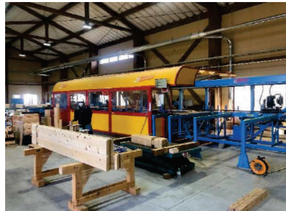
写真 5-2 CLT ログ加工機
