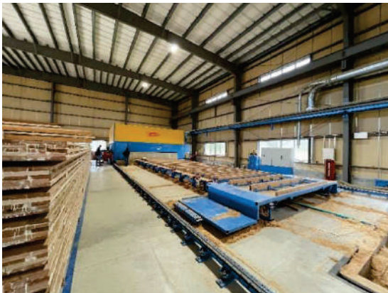
写真 5-1 CLT の原版加工機
