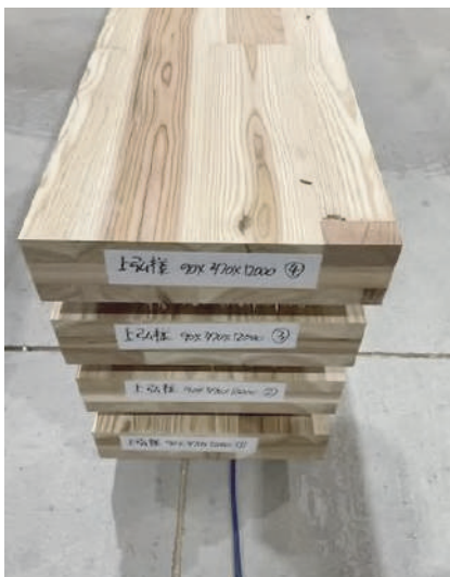
○ 規格寸法がW=2,300の為、屋根として使わない余りの部分を階段の踏板として活用する
