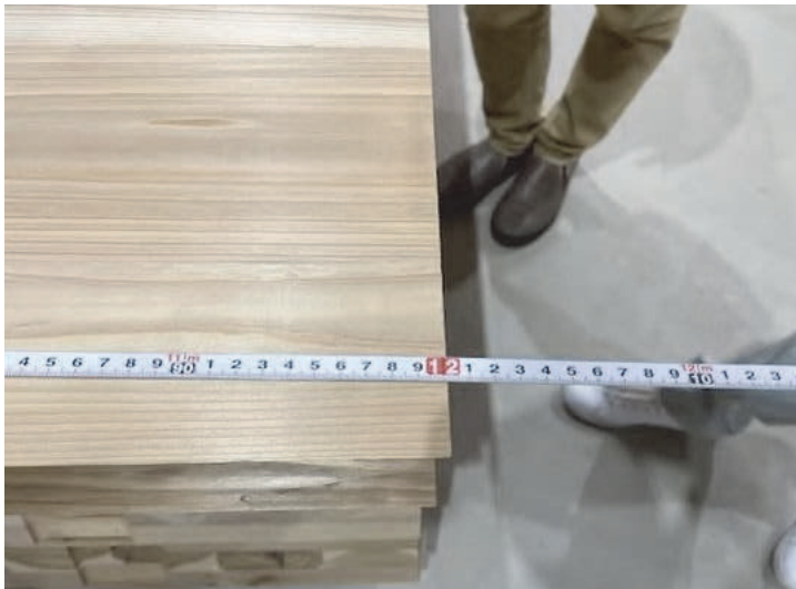
○ L=12のCLT実測の様子
