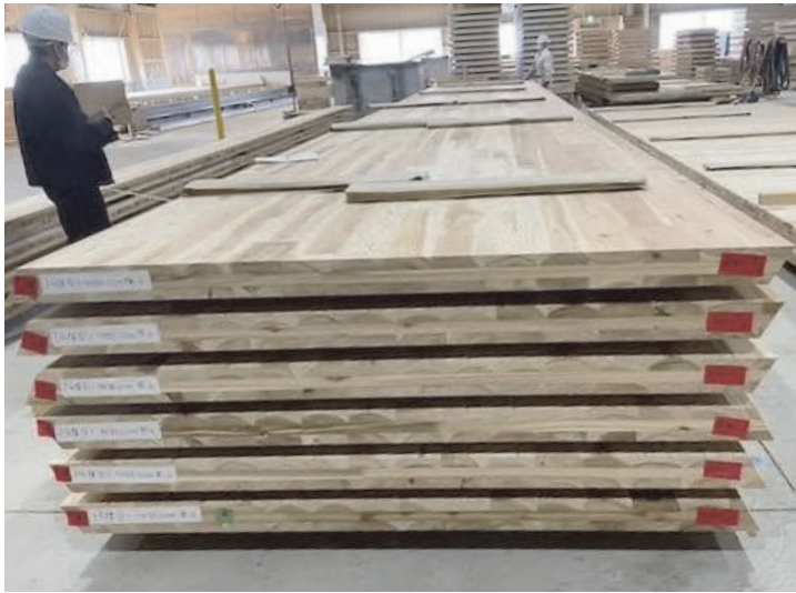
○プレカットされたCLT折版屋根
