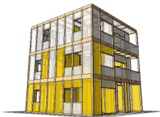
3階建て軸組構法(日加共同研究)
