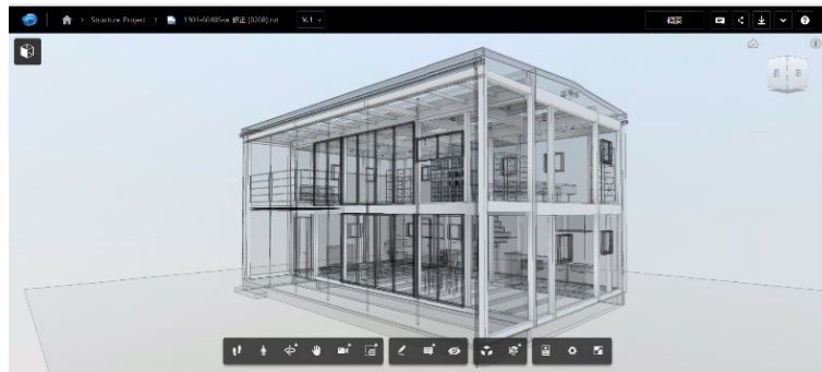
図 2.1-1 3 次元 CAD による干渉チェックの例
