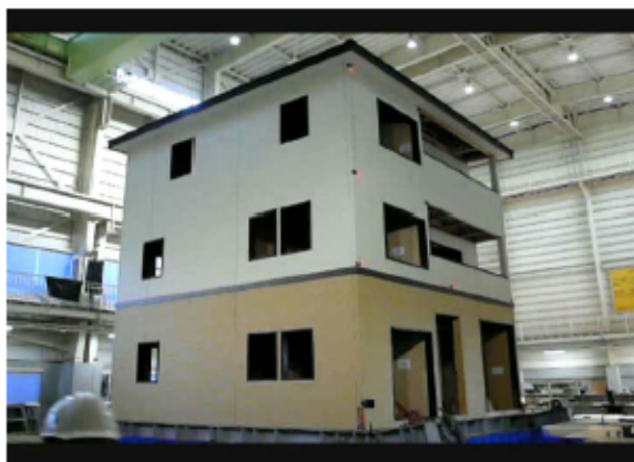
3階建て軸組構法(日加共同研究)
