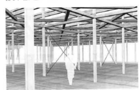
図7 格子梁架構イメージ
