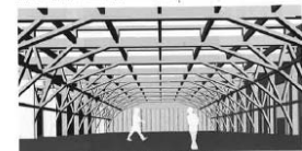
図8 トラスアーチ架構イメージ
