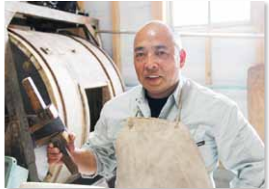
▲太鼓をつくる上で欠かせない牛皮の厚みを整える「皮かんな」
