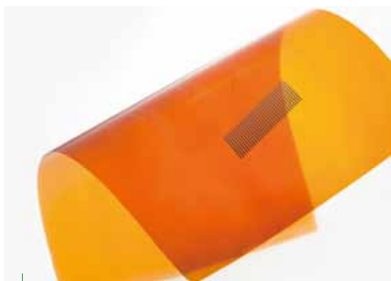
改質リグニンをハイブリッドフィルムを用いた電子基板 写真：産業技術総合研究所
