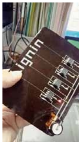
改質リグニンをハイブリッドフィルムを用いた電子デバイス 写真：産業技術総合研究所
