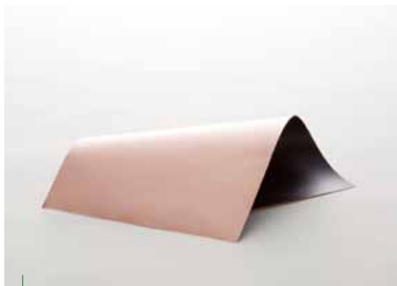
銅箔をコーティングした改質リグニンハイブリッドフィルム 写真：産業技術総合研究所、住友精化(株)
