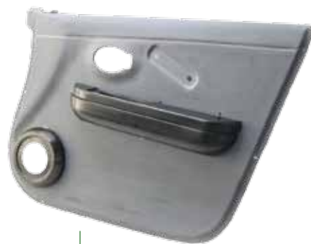
改質リグニンを用いた繊維強化材で製造した自動車用ドア部材
