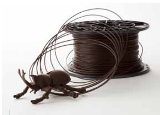
改質リグニンを用いた生分解性3Dプリンターフィラメントと成形物 写真：森林総合研究所、ネオマテリア㈱
