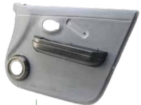
改質リグニンを用いた繊維強化材で製造した自動車用ドア部材
