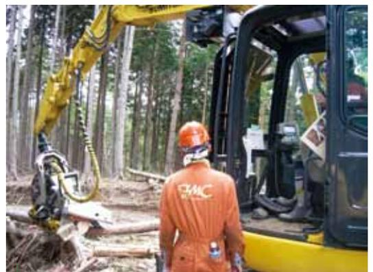
高性能林業機械（安全指導）研修の様です。ハーベスタ等機械の特性や操作を体験しながら、機械の死角や遵守すべきことなど現場での安全指導の基礎知識を学習します。※ハーベスタとは、従来チェーンソーで行っていた立木の伐倒、枝払い、玉切りの各作業と玉切りした材の集積作業を一貫して行うことが可能な自走式の機械です。
