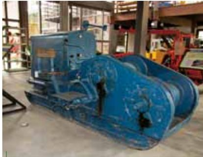
岩手富士産業（現イワフジ工業株式会社）が1950年に完成させた2胴式の集材機です。2胴遠心クラッチとフリーホイールにより自走変速が可能で取り扱いが簡単だったことから、各地で数多く導入されました。日本の集材作業の機械化に大きく貢献した機械の一つです。
