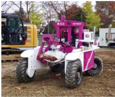
リモコン操作の小型伐倒機械
