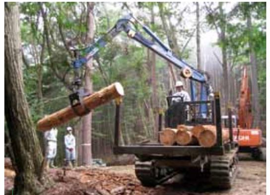
高性能林業機械（基礎）研修の様です。機械の機能や特性、操作方法について、基礎的な知識を学習します。手前がフォワーダで、奥に見えるのはプロセッサです。※フォワーダは、グラブローダで材を荷台に積んで運ぶ集材専用の機械です。プロセッサは、材の枝払い、玉切りの作業と玉切りした材の集積作業を一貫して行うことが可能な自走式の機械です。
