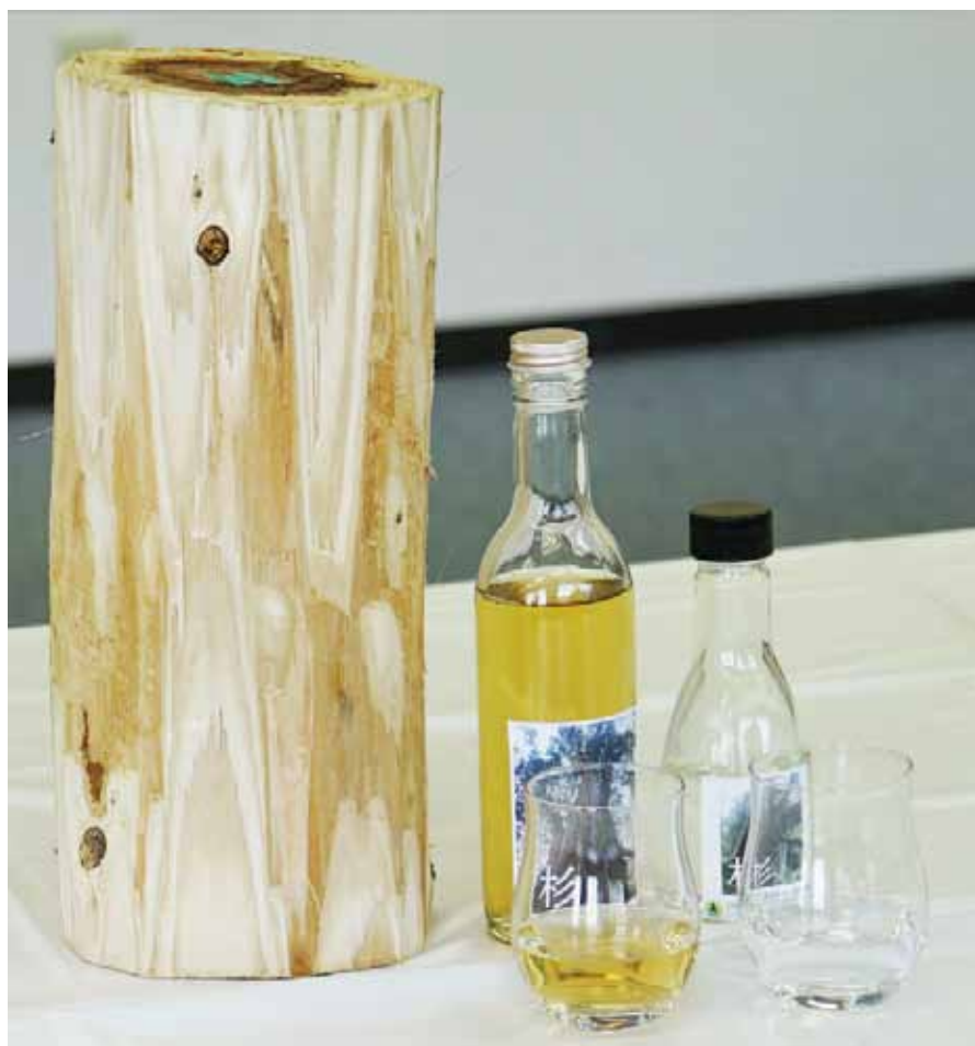
図4. スギから製造したアルコール（発酵液と蒸留物）
