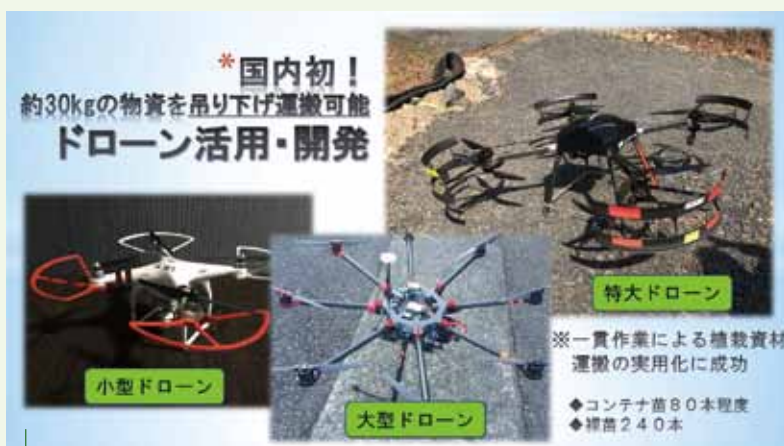
開発した「特大ドローン」と市販のドローン
