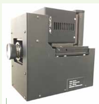
近赤外分光カメラ (MCT (HgCdTe) センサ搭載・米国製)
