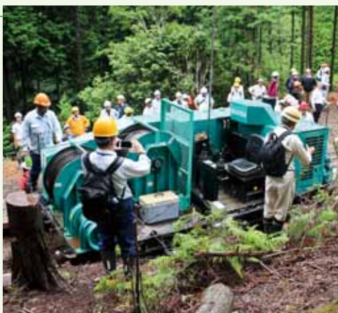
開発した「油圧式集材機」とコンテナ苗木の運搬
