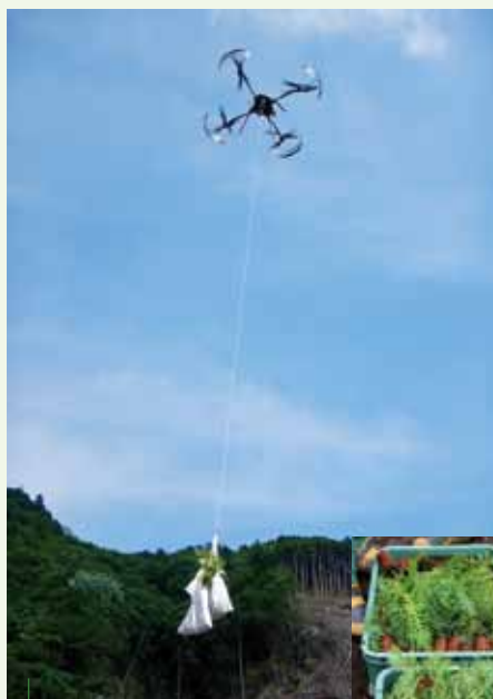
「特大ドローン」による コンテナ苗木の運搬
