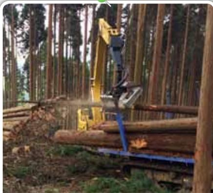
プロセッサによる造材作業
