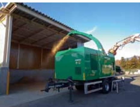
根曲がり材や低質材を使用し燃料用木質チップを製造
