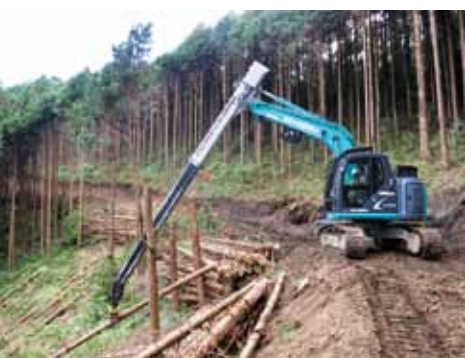
ヘッド固定式ロングリーチグラップルで、より安全・効率的に木寄せや集材を行っている
