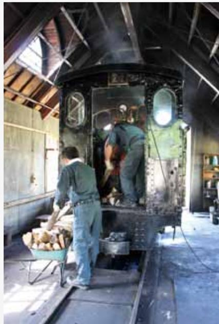
写真2 ボイラーに燃料の薪を投入し発車準備
