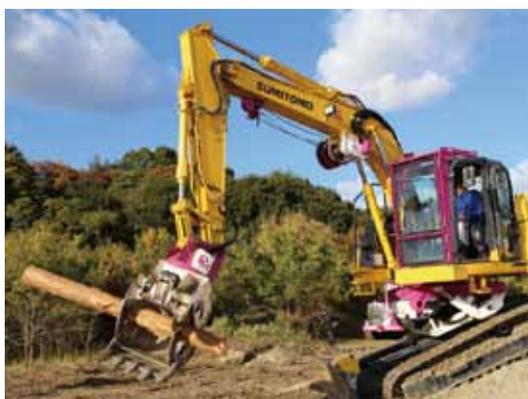
傾斜に対応した伐倒装置付きグラップルバケット
