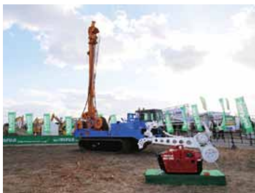
タワーヤーダと自走式搬器
