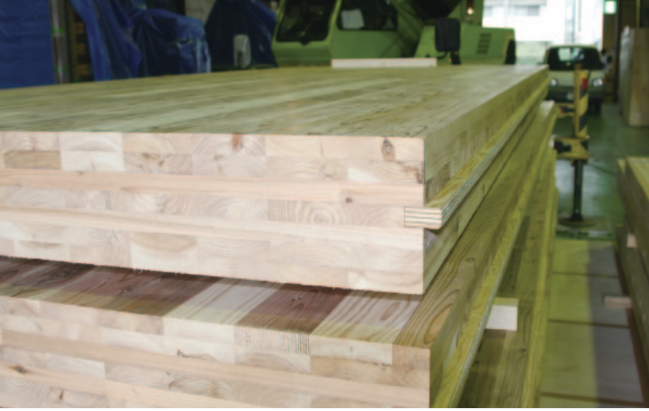
建築に使われるCLTパネル
