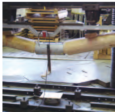
接合間伐杭の曲げ試験
