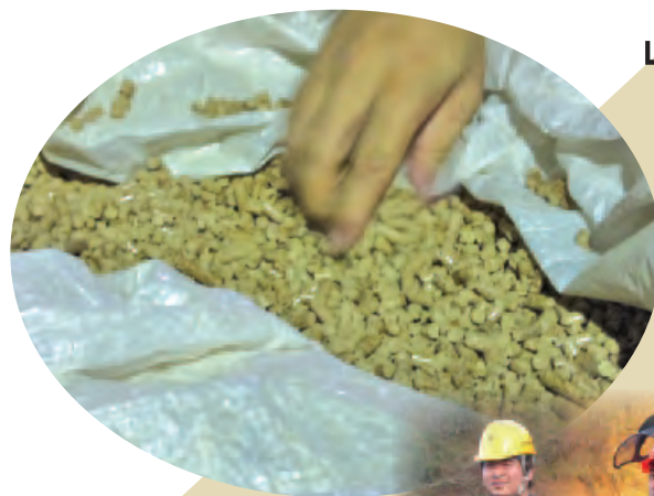
木材加工時に出る端材やかなな屑などを圧縮成形した木質ペレット。
