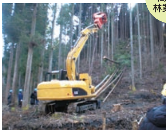
スイングヤード（簡易架線集材機） アームをタワーとして使用し、主索を用いない簡易な架線による集材機
