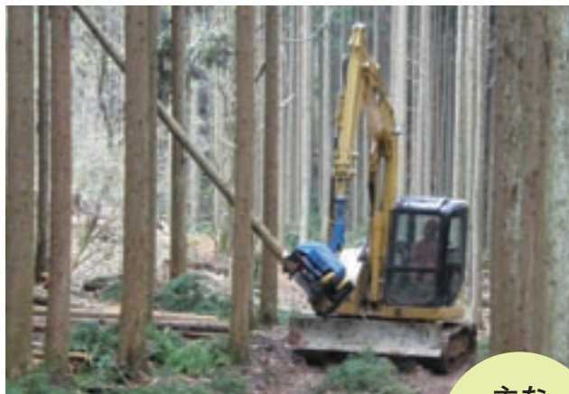
ハーベスタ（伐倒造材機） 伐倒・枝払・玉切・集積を一貫して行う自走式機械
