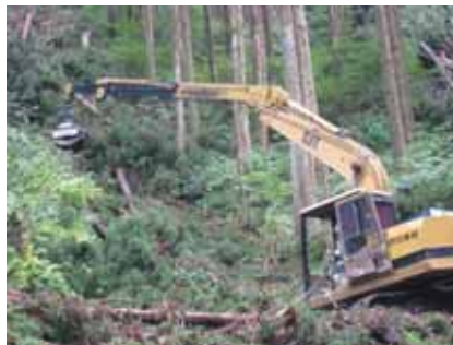
グラップルによる木寄せ 路網を整備し、グラップルで木寄せを実施。高い生産性が期待できる
