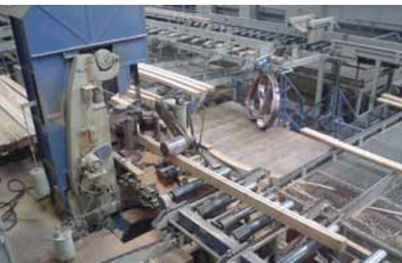
ツインセンターで残った材を曲がりに合わせて半割りする
