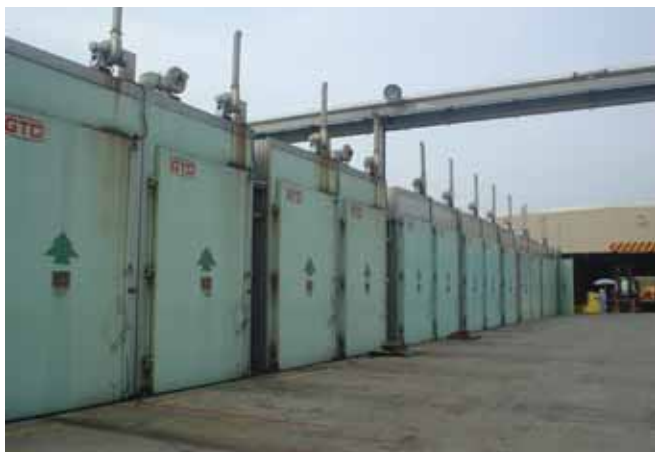
同事業所の人工乾燥機は容量100m 3 が25基と50m 3 が5基。80tを掛けて含水率を5.5～7%にまで落とす。この段階でラミナのはほとんどが解消される
