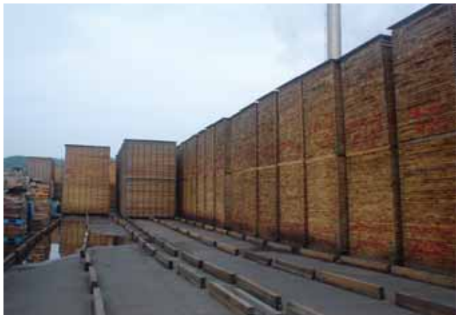
伊万里事業所では未乾燥材を受け入れたラミナをまず天然乾燥する。上部には1.2tの重しを載せ、人工乾燥機にはさらに重い4tの重しを載せかえる
