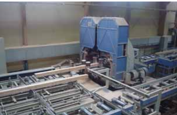
ツインセンターで曲がりに合わせて3分割。木取りは幅に応じて決める
