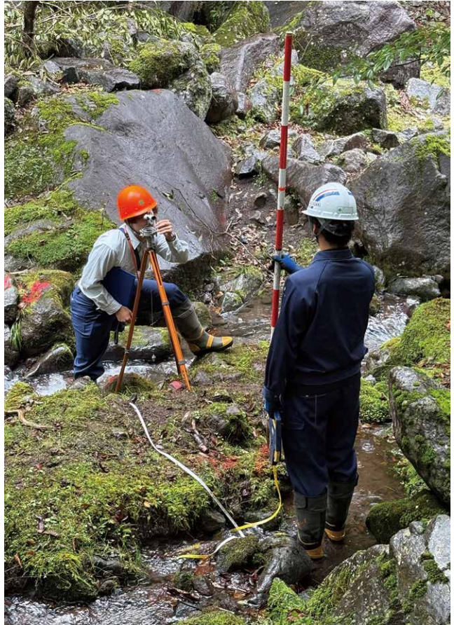
溪間工の設計のための現地測量
