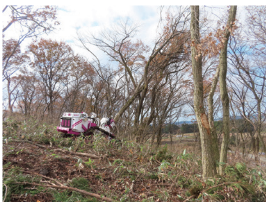
遠隔操作式小型伐倒作業車
