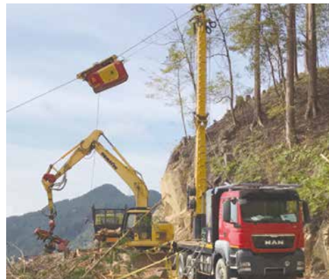
タワーヤードによる集材作業
