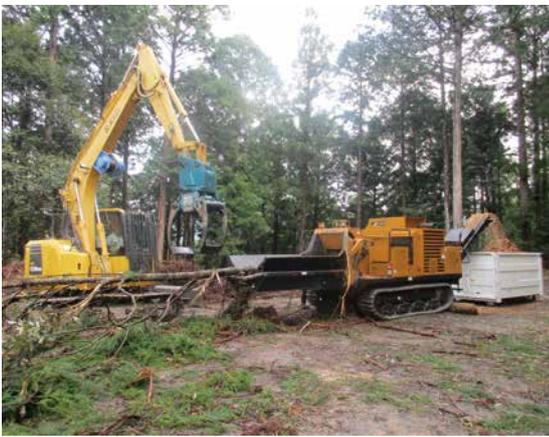
木材破砕機による破砕作業
