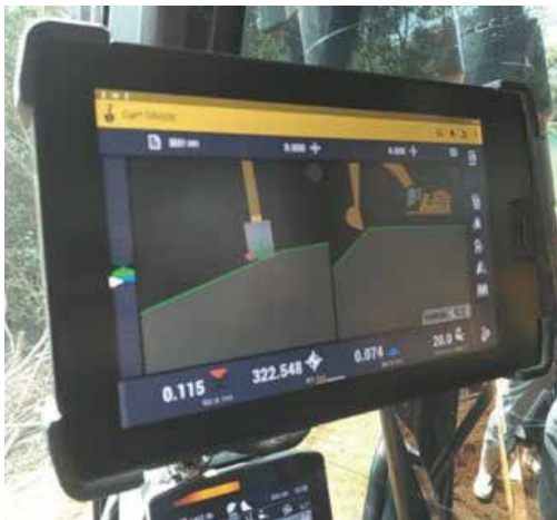
自動追尾式トータルステーションを活用したICT建設機械の活用
