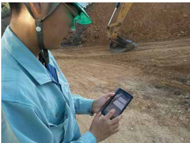
携帯端末のLiDAR機能を用いた点群作成と測量検証
