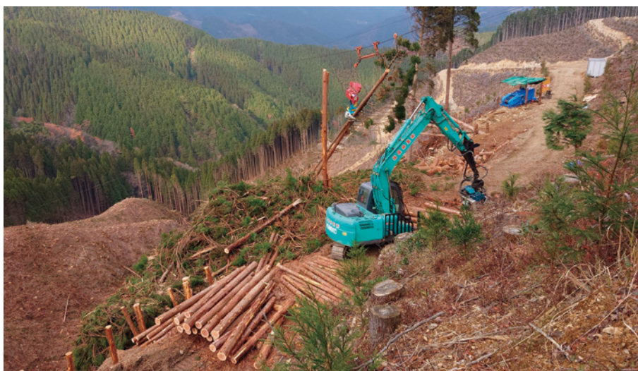
架線式グラップルによる集材作業
