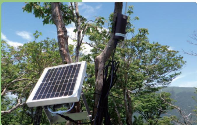
写真6 ICT捕獲通知システムの中継器
