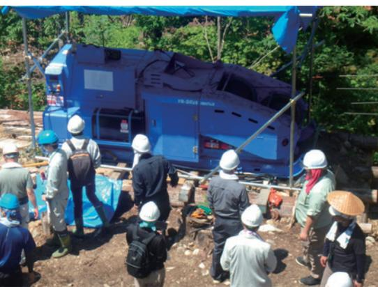
図1 最新式油圧集材機
