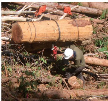
図5 従来型のフックとスリングによる荷掛け
