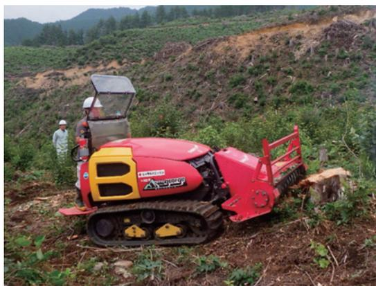
図4 乗用刈払機による伐根処理
