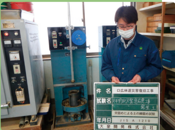
写真7：土砂の土質試験
