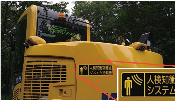
バックホウに装備した360度カメラと人検知衝突軽減システム
