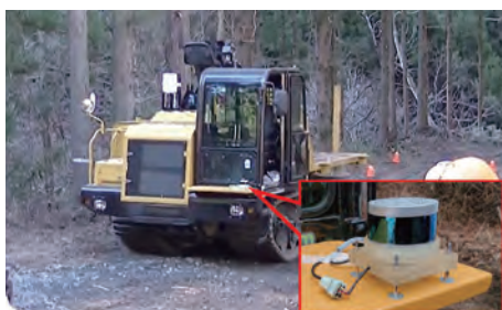
・フォワーダの遠隔操作走行の実現 ・20m程度の自動走行に成功 (令和2年度)
